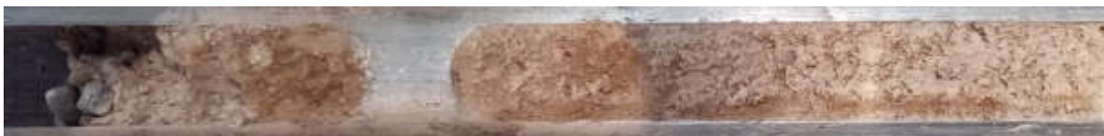
Bild 5 Oberflächenabschluss mit Schotter und Übergang zu Schwemmlehm (RKS 4)
