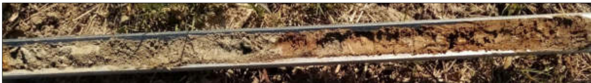
Bild 9: Tonstein / Schluffstein und Mergelstein (vollständig verwittert) in der Bohrsonde der RKS 2
